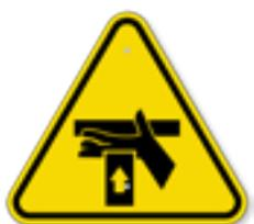
Der MS-I140 hebt und senkt sich elektrisch nach Betätigung des entsprechenden Schalters. Man sollte gut darauf achten, dass sich keine Gegenstände oder Personen unter der Last (z.B. Fahrrad oder E-Bike) befinden.
