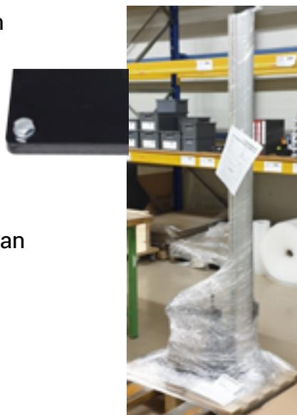
Heben Sie den Ständer mindestens zu zweit von der Palette. Der MS-I140 wiegt ca. 50 kg. Heben Sie den Ständer niemals an der Fahrradklemmvorrichtung oder der dazugehörigen Montageplatte an. Stellen Sie den MS-I140 an einen dafür ausgewiesenen Arbeitsplatz, in der direkten Umgebung der Stromversorgung.
